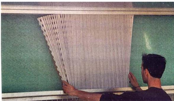
③ Den Farbnebelabscheider vollkommen in den Rahmen mit gleichmäßigen Faltabständen ausstrecken und dessen beiden Enden hinten in die Schrauben einstecken.
